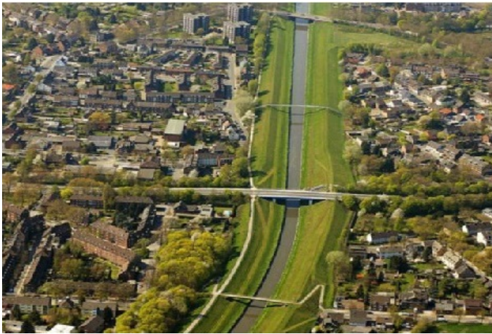
Figure 6.7 Levees at the Emscher river in Oberhausen (Photograph Emschergenossenschaft-Lippeverband in GRÜN, JOHANN, PFISTER 2014)
